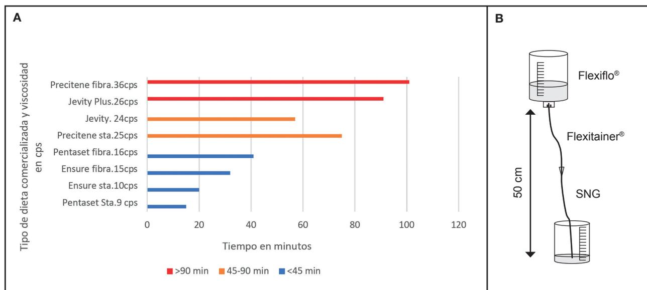
**Figura 9.** A. Tipos de dietas enterales. Relación entre la viscosidad y el tiempo de caída libre por sonda de 8 Fr (Fuente: Montejo O, et al. Nutr Hosp 2001;16:41-5). B. Método de ensayo. Tipo de dieta, diámetro de SNG y tiempo de caída libre.
